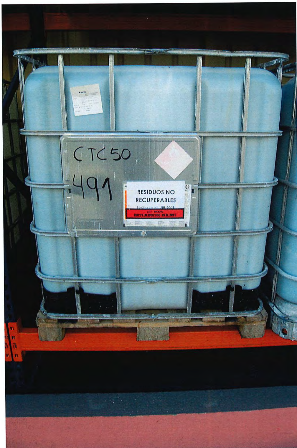
4 - DETALL DE SISTEMA D'ESTIBA I IDENTIFICACIO DELS RESIDUS LIQUIDS
