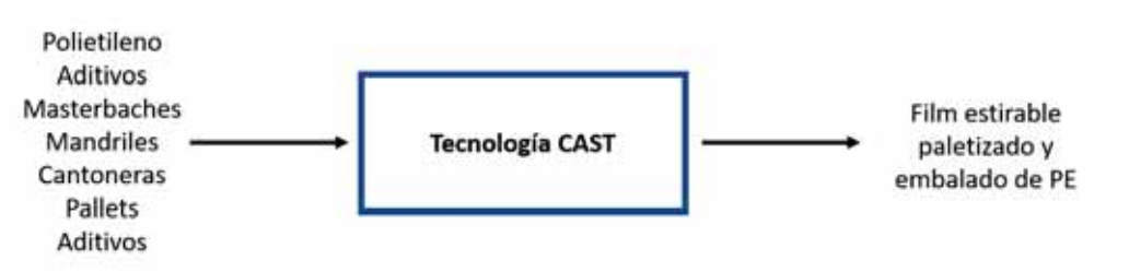
Figura 6. Diagrama de flujo proceso de extrusión Cast.
