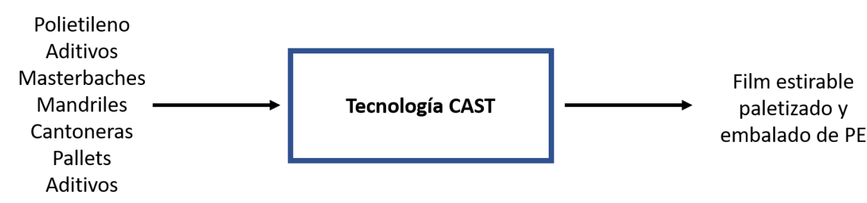
Figura 6. Diagrama de flujo proceso de extrusión Cast.
